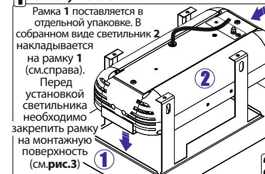
**Установите** рамку 1 на монтажную поверхность и закрепите ее с помощью 2-х(4-х) винтов, болтов, анкеров (в комплекте не входят).
