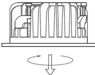
2 Подготовить в навесном потолке отверстие для установки светильника.
